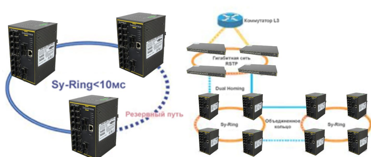
Рисунок 16 – Технология кольцевого резервирования
