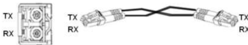
Рисунок 8 – Волоконно-оптическое соединение SFP-модуля
